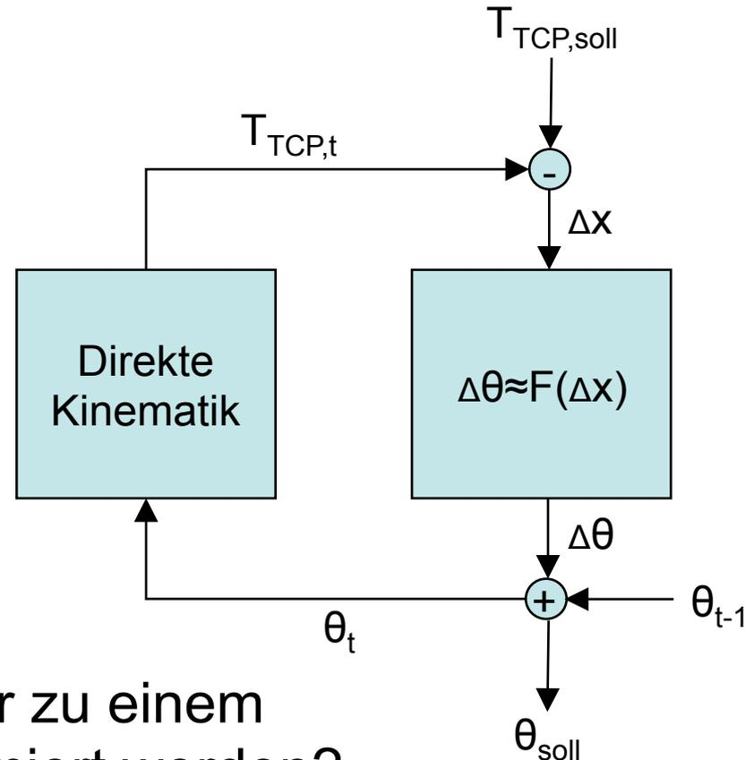
Wie kann der Gelenkwinkelfehler zu einem Fehler in der TCP-Lage approximiert werden?
